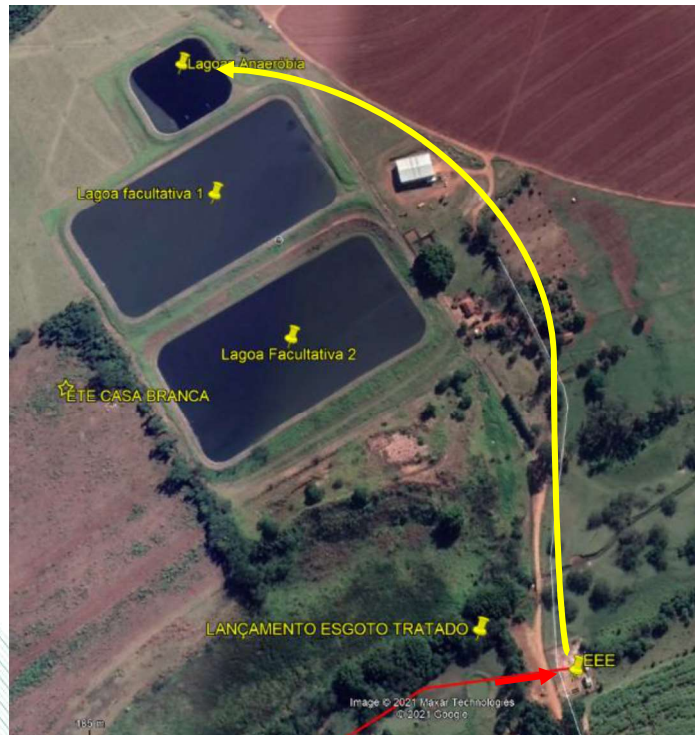
Figura 99 - Fluxograma do esgoto na ETE Casa Branca
