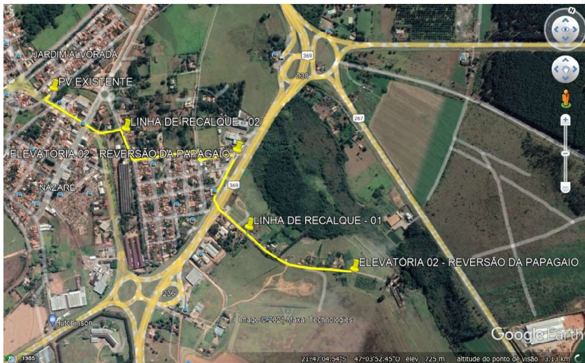
Figura 97 - EEE Papagaio e local de lançamento da reversão em PV de rede existente
